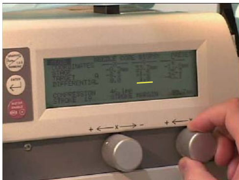
図18 Y値DIFFERENTIALを+2.0mmにあわせる
